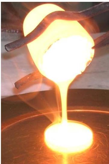
Préparation d'un verre de silicate par fusion + trempe en laboratoire.
